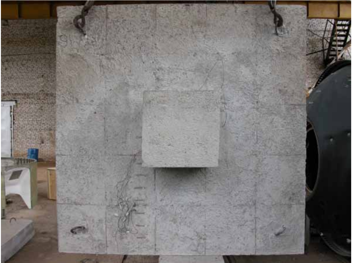
Рис. 3.25 – ФПП-5 (М6) после разрушения. Верхняя грань фрагмента плиты
