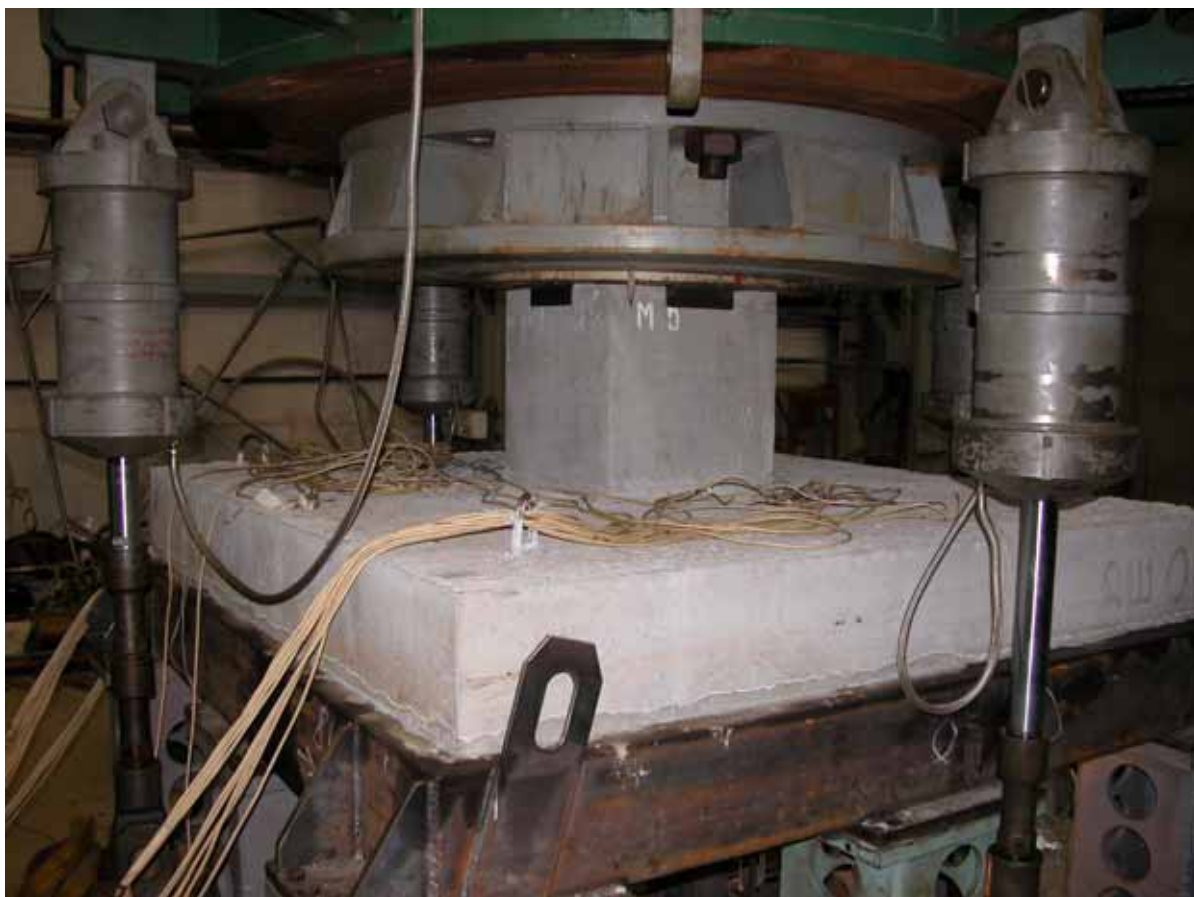
Рис. 3.12 – ФПП-4 на испытательном стенде. Вид сверху по диагонали
