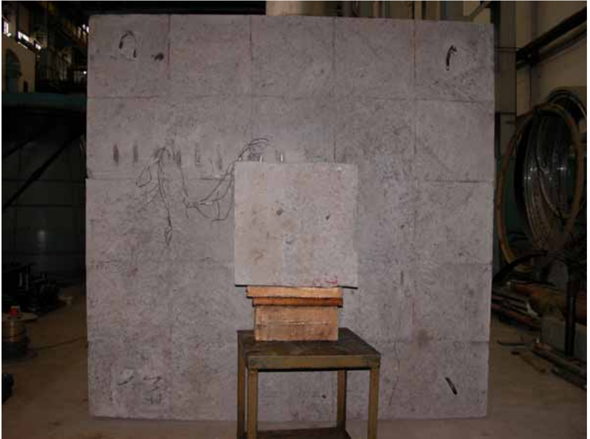
Рис. 3.27 – ФПП-6 (М7) после разрушения. Верхняя грань фрагмента плиты
