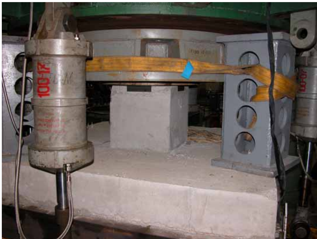
Рис. 3.17 – ФПП-1 (М2) на испытательном стенде после разрушения. Вид сверху
