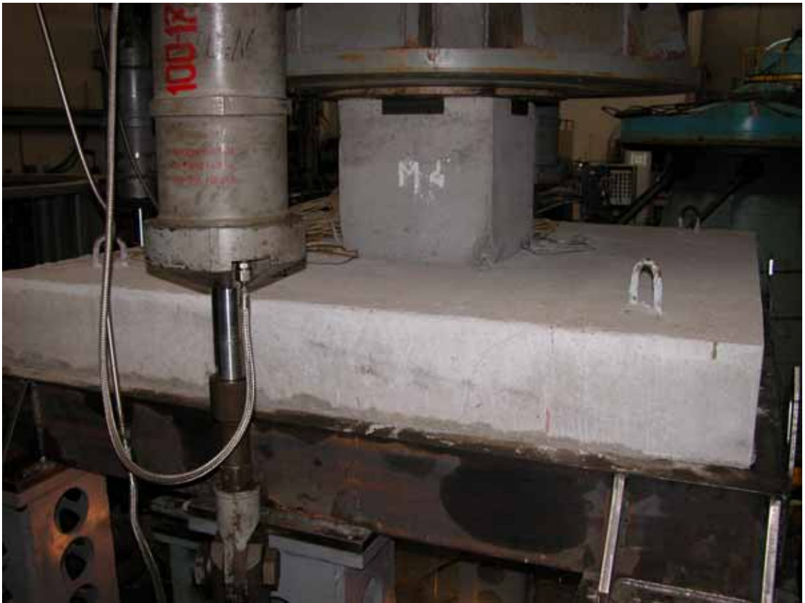
Рис. 3.21 – ФПП-3 (М4) на испытательном стенде после разрушения. Вид сбоку
