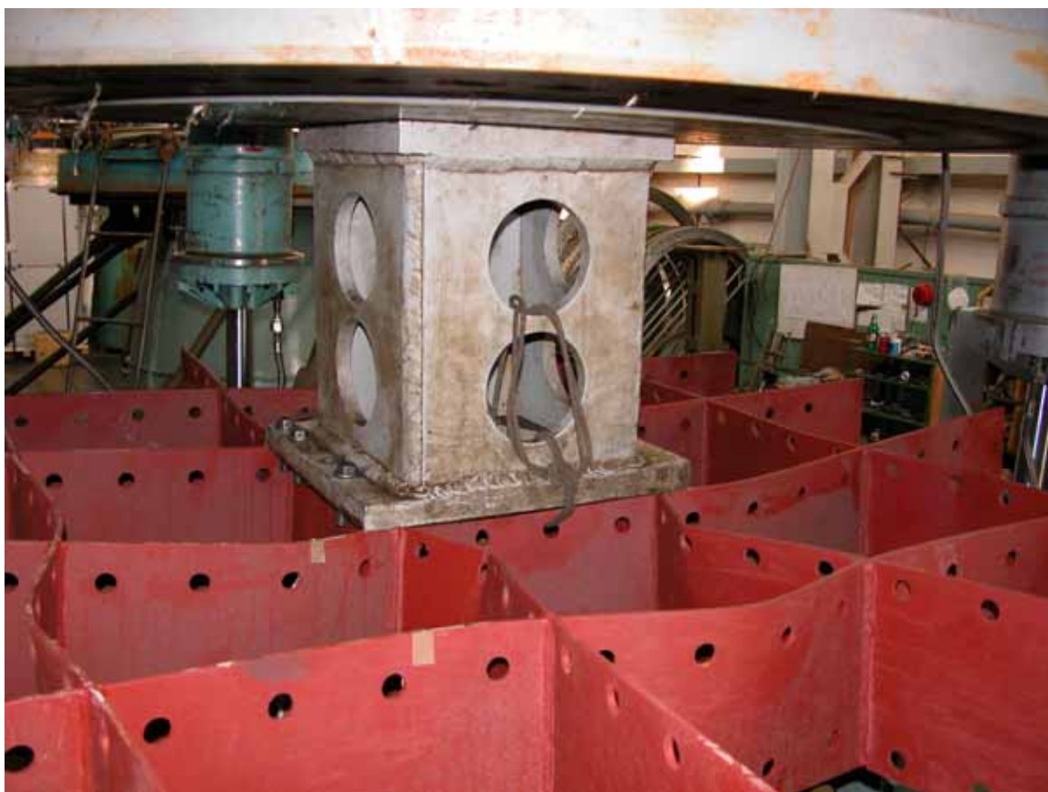
Рис. 3.16 – МК-1 (М1) на испытательном стенде после разрушения
